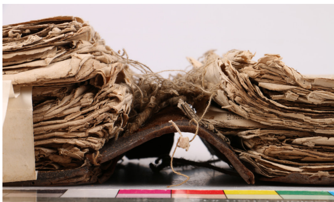
Obr. 2 Detail na hlavicu a roztvorený knižný blok pred reštaurovaním. Foto: Eva Barbuščíková
