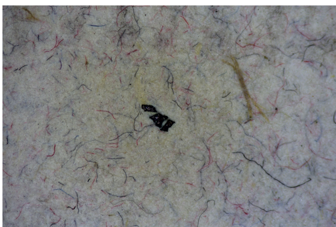
Obr. 3 Detail struktury papíru a korodující úlomek kovu pod stereomikroskopem, zvětšeno. Foto: Jana Háková
