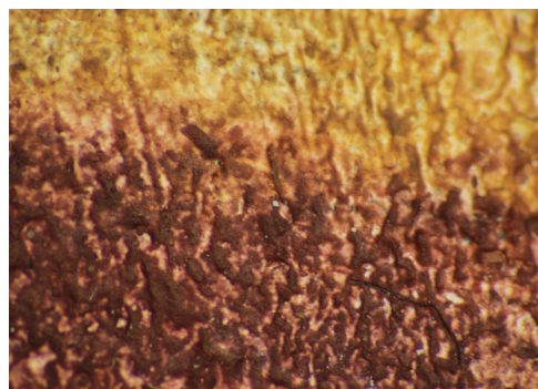
Obr. 8 Barevná vrstva akvarelových barev Winsor & Newton™ Water Colour před umělým stárnutím. Snímek z optického mikroskopu při zvětšení 20×. Foto: Barbora Vařejková.
